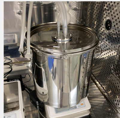
スケールアウトのための細胞農業仕様のバイオリクター 圧力釜を再利用した低コストのバイオリクター
