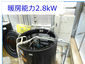
試作・開発中の施設園芸用ヒートポンプ (10馬力機) と改良 (農研機構)
