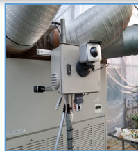
高精度環境計測・制御装置/センサーネットワーク (慶應義塾大学、ホルトプラン、農研機構)
